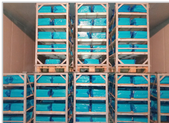
RO: CONGELAREA PRODUSELOR - RAPIDĂ ÎN TUNEL 24H (-18 ... -25°C) - ÎN CUȘTI EN: PRODUCTS FREEZING - TUNNEL AIR BLAST FREEZING 24H (-18 ... -25°C) - IN CAGES HU: TERMÉKEK FAGYASZTÁSA - GYORSFAGYASZTÁS 24H (-18 ... -25°C) - KETRECEKBEN
