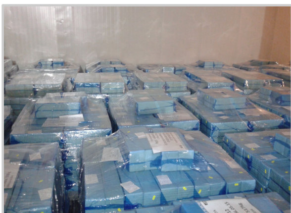
RO: CONGELAREA PRODUSELOR - LENTĂ ÎN 8 ZILE (-18° ... -20°C) - ÎNTINS EN: PRODUCTS FREEZING - SLOWLY IN 8 DAYS (-18° ... -20°C) - SPREAD HU: TERMÉKEK FAGYASZTÁSA - LASSÚ FAGYASZTÁS 8 NAP (-18° ... -20°C) - SZÉT TERÍTVÉ
