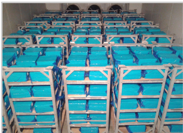
RO: CONGELAREA PRODUSELOR - RAPIDĂ ÎN TUNEL 24H (-18 ... -25°C) - ÎN CUȘTI EN: PRODUCTS FREEZING - TUNNEL AIR BLAST FREEZING 24H (-18 ... -25°C) - IN CAGES HU: TERMÉKEK FAGYASZTÁSA - GYORSFAGYASZTÁS 24H (-18 ... -25°C) - KETRECEKBEN
